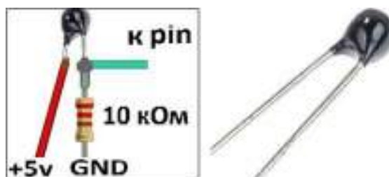
Рис. 3. Схема подключения к микроконтроллерной плате терморезистора
