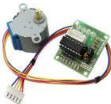
Рис. 20. Шаговый двигатель 28BYJ-48
