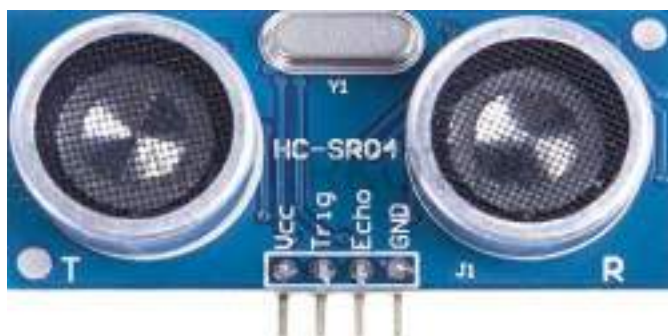
Рис. 16. Ультразвуковой датчик (дальномер)
