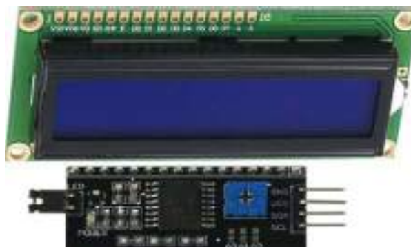
Рис. 17. Дисплей (жидкокристаллический индикатор — ЖКИ 16×2)
