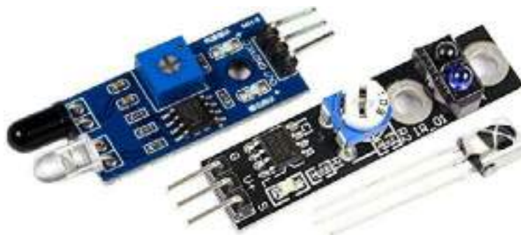
Рис. 15. Инфракрасный датчик (датчик линии)
