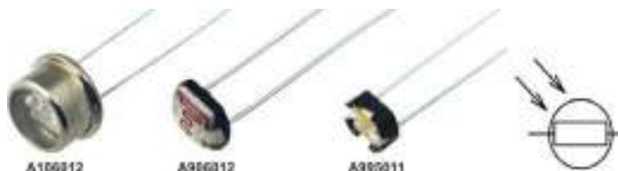
Рис. 12. Фоторезисторы и их обозначение
